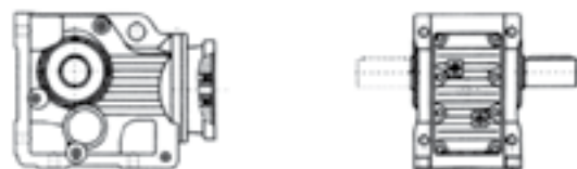
JCKA(JCK、JCKF、JCKAF、JCKAB、JCKAZ)..JCY.. 电机用户自配或配特殊电机时需加联接法兰，长度见第 203 页
