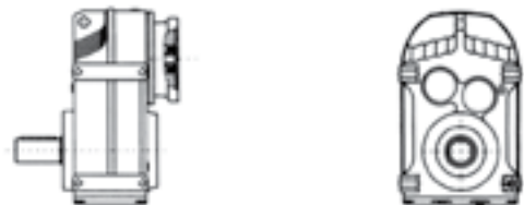
JCF(FF、FA、FAF、FAZ)..Y.. 电机用户自配或配特殊电机时需要加联接法兰，长度见第 203 页
