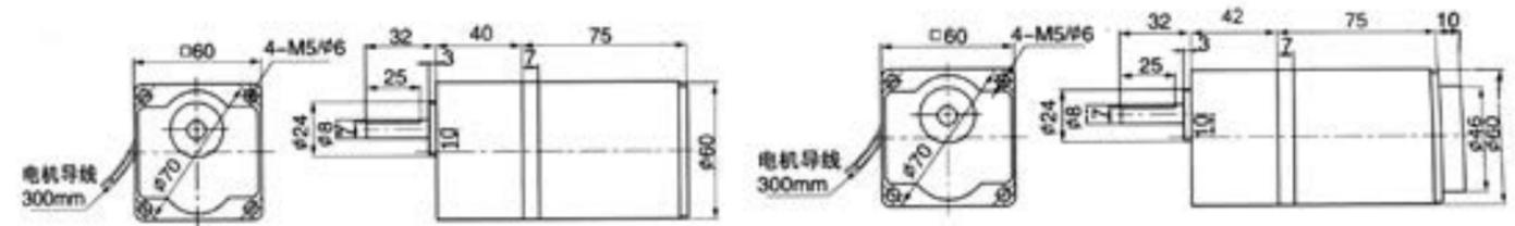
结构：减速器 + 电动机
