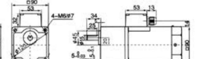
结构：减速器 + 电动机 + 端子箱
